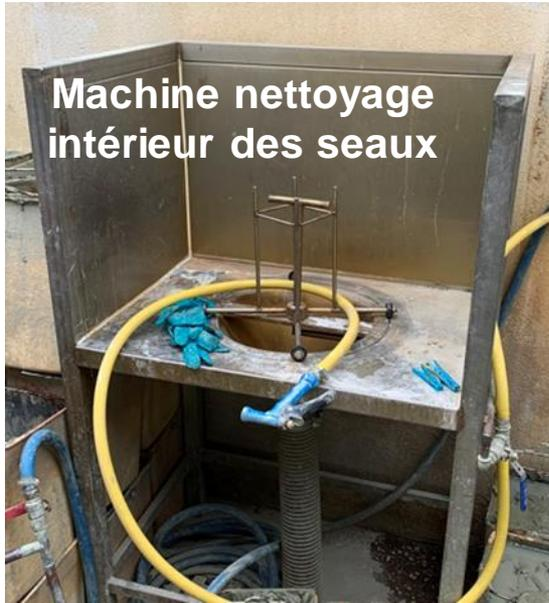
Machine nettoyage intérieur des seaux
